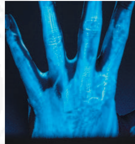
Bild 3-13: Typisches Beispiel für unzureichenden Hautschutz im Bereich der Fingerzwischenräume
