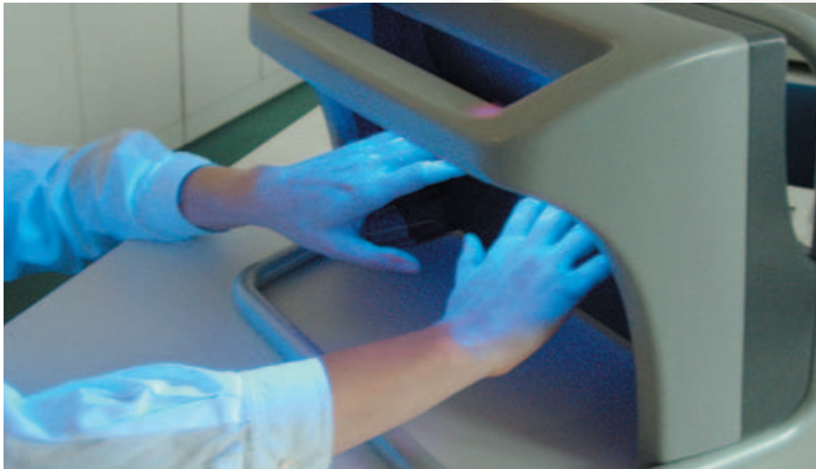
Bild 3-12: Testgerät (UV-Lampe) zur Überprüfung des Hautschutzes
